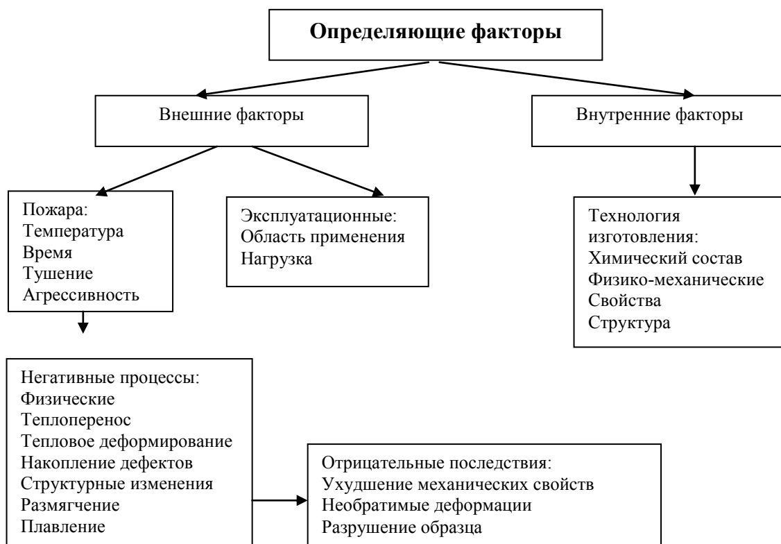
Рис.1. Структурная схема поведения стальных конструкций в условиях пожара
