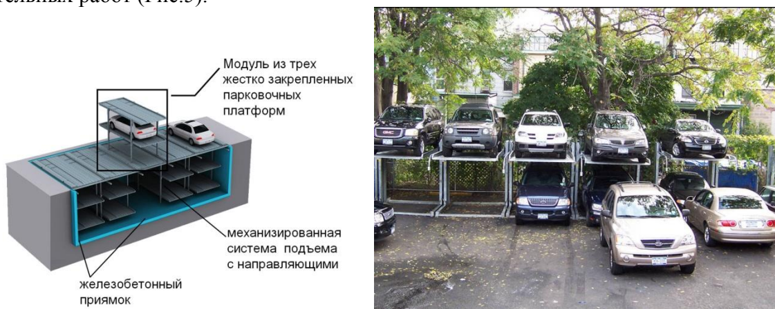
Рис. 5 – Типы парковок: а - трёхуровневая механизированная парковка; б – мини-паркинг.
