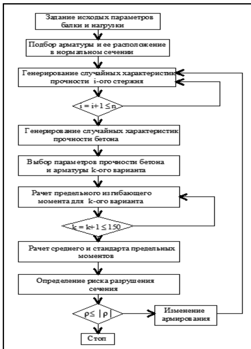
Рис. 2 Блок-схема полностью вероятностного расчета риска возникновения предельного состояния нормального сечения со стержневой арматурой
