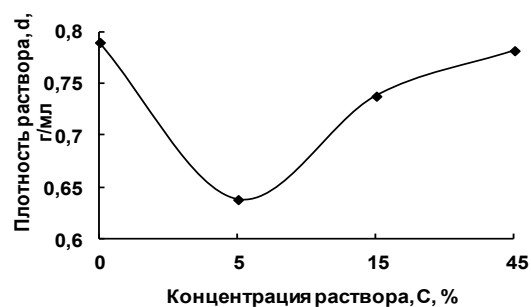
Рис. 2. Зависимость плотности (d) раствора от концентрации олигомера (C)
